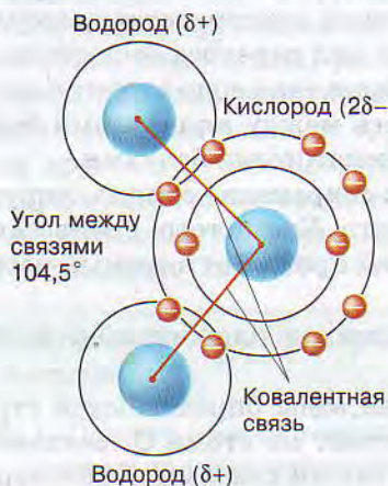
Рис. 6. Схема строения молекулы воды
